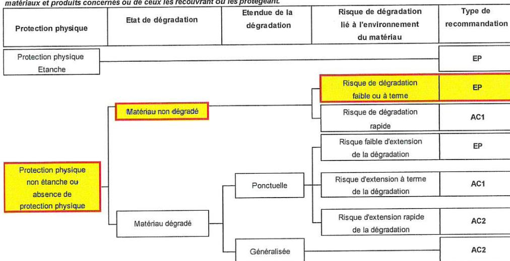
EP = évaluation périodique; AC1 = action corrective de premier niveau; AC2 = action corrective de second niveau
